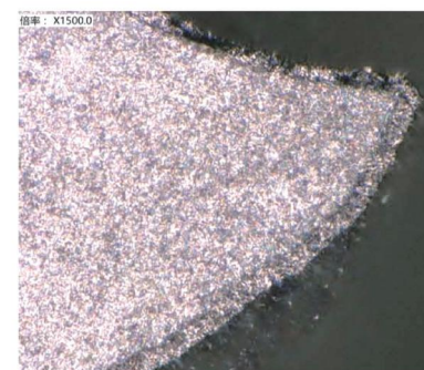
D1.0铣刀断面图 D1.0 Milling cutter profile 1500X
